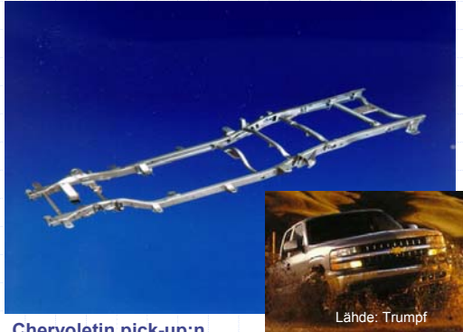
Chervoletin pick-up:n laserleikkaamalla rajattu runkopalkisto
